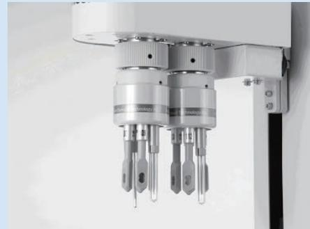
センサープローブ（計測部）
